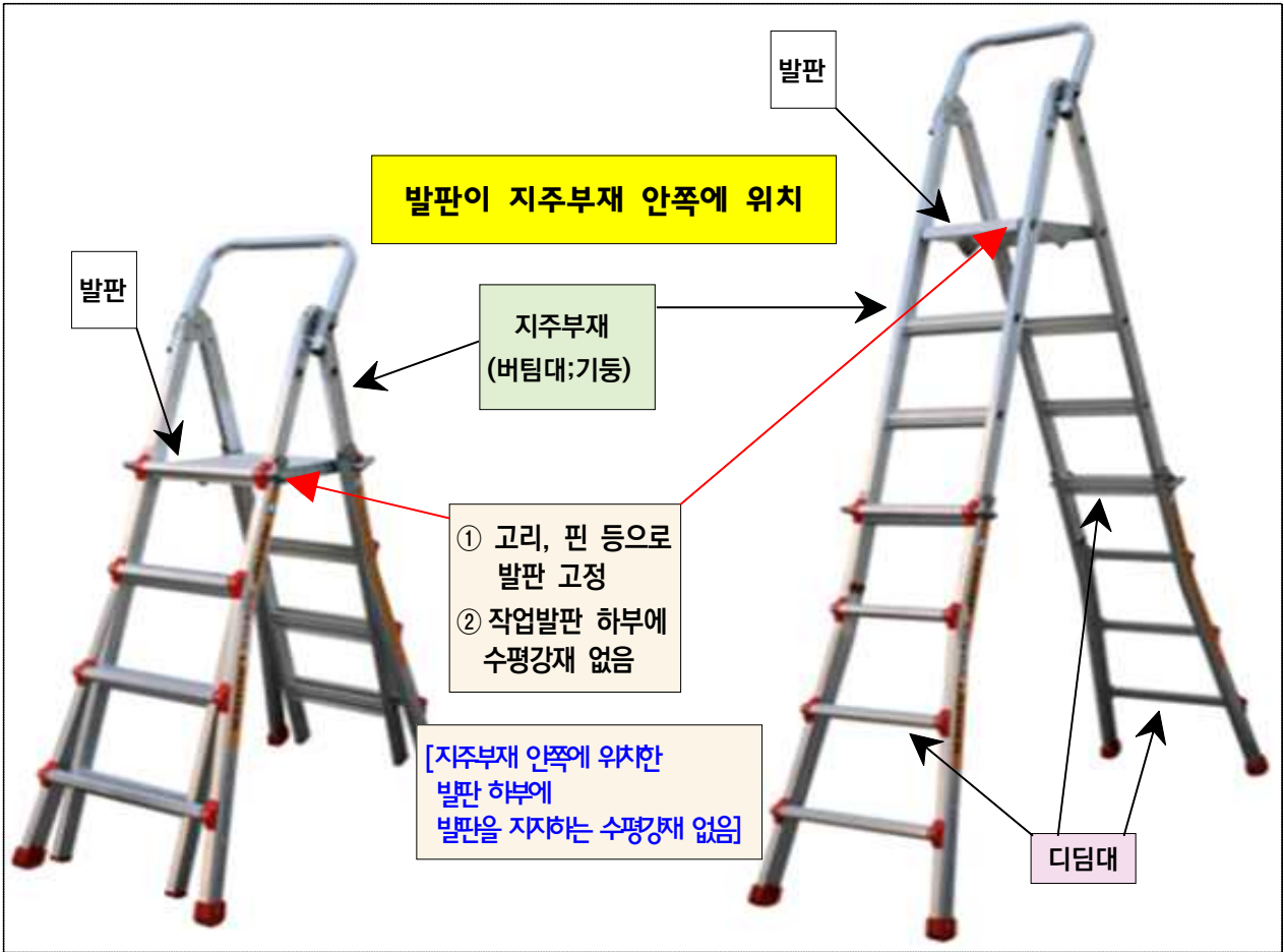
[발판이 지주부재 안쪽에 설치된 사다리 (하부에 수평강재없음) ; 작업발판으로 사용 불가]
