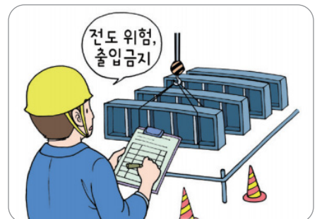
거더 등 부재의 좌굴 또는 변형방지 조치
